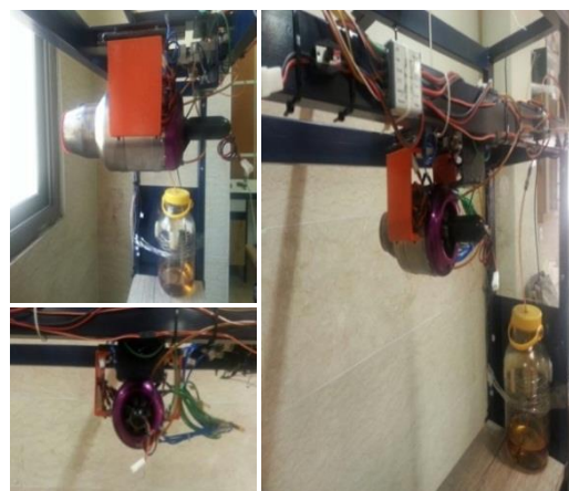
شکل ۴. تصاویر موتور میکروتوربین گاز آزمایشگاهی مورد استفاده در مطالعه حاضر به همراه چارچوب تست آن
