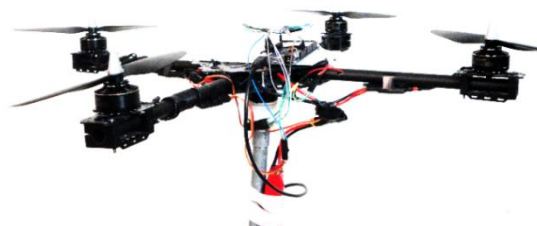
شکل ۸. نحوه قرارگیری ربات روی پایه با سه درجه آزادی
