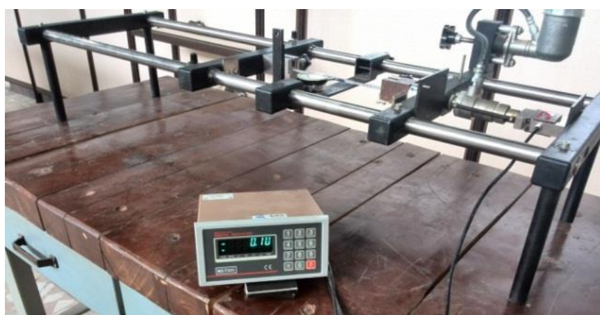
شکل ۱۲. تجهیزات آزمون تجربی تعیین بار بحرانی کمانش فلکسچر
