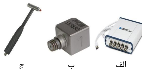
شکل ۱۵- الف) شتاب‌سنج (ب) چکش ضربه (ج) دستگاه تجزیه و تحلیل‌کننده
