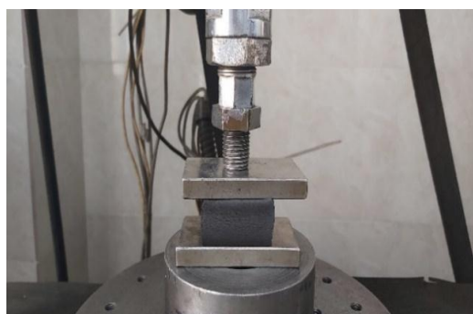
شکل ۷- سنجش میرایی میراگر با دستگاه تست دینامیک هارمونیک
