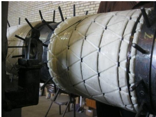
شکل ۲. فرایند رشته‌پیچی و ساخت نمونه
