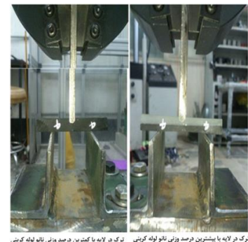
شکل ۲. دستگاه تست خمش سه نقطه‌ای.
