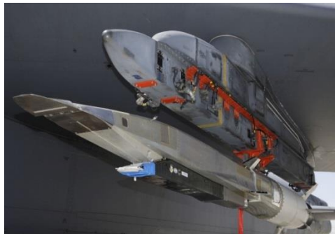
شکل ۲. پرنده ایکس-۵۱ با موتور اسکرمجت [۷]
