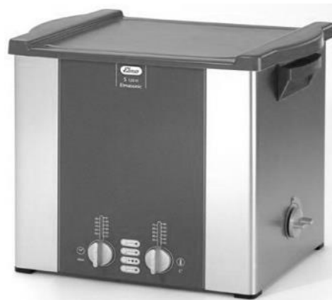
شکل ۲. حمام التراسونیک جهت همگن سازی سوخت
