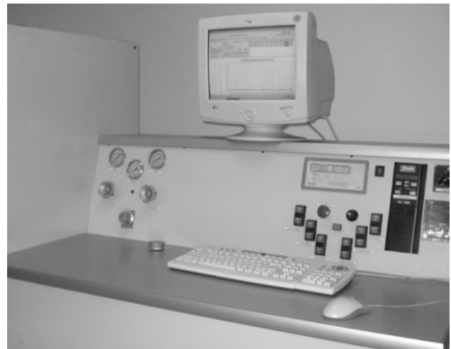
شکل ۴. دستگاه آزمون هیدرواستاتیک ساخته شده در آزمایشگاه مکانیک انفجار جهت همین پروژه
