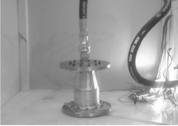
شکل ۵. نحوه قرارگیری سازه و بارگذاری در دستگاه هیدرواستاتیکی
