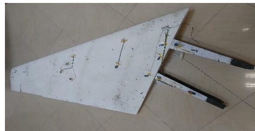
شکل ۱۰. کرنش سنچها نصب شده بر روی بال
