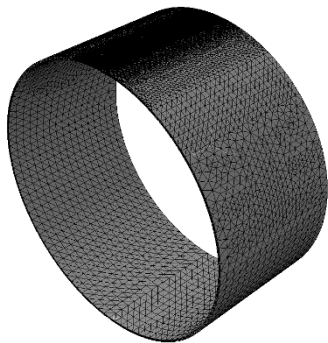
شکل ۳. مدل المان محدود سه‌بعدی پوستهٔ آلومینیومی
