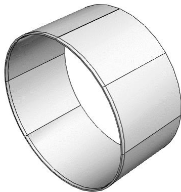
شکل ۷. تقسیم‌بندی استوانه برای مدلسازی پوسته ترک‌دار
