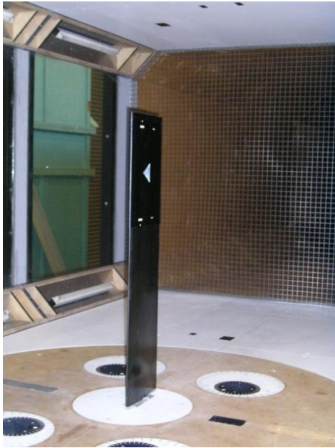
شکل ۱. محفظه‌ی آزمون تونل باد و مدل بال صدمه‌دیده‌ی نصب‌شده در آن
