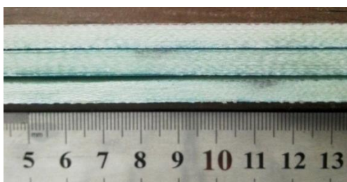
شکل ۱. نمونه‌های کامپوزیتی الیاف شیشه / اپوکسی
