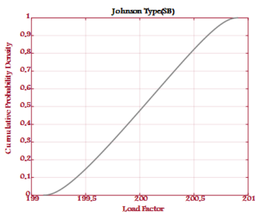
شکل ۱۱. نمودار احتمال تجمعی برای بار بستر کاتالیستی با توزیع جانسون
