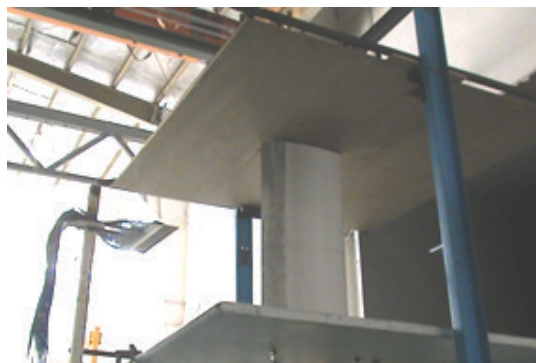
شکل ۴. ریک فشاری نصب شده در پشت مدل در مقطع آزمون تونل باد
