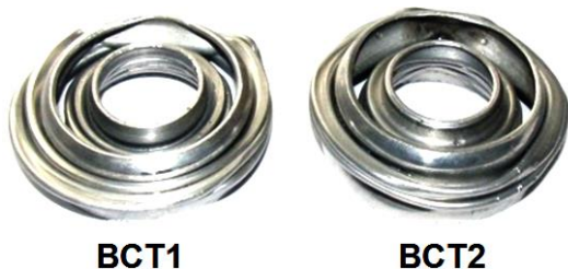
شکل ۴. فروریزش نهایی نمونه‌های مخروطی دوجداره تحت شرایط مرزی دوسرگیردار محوری
