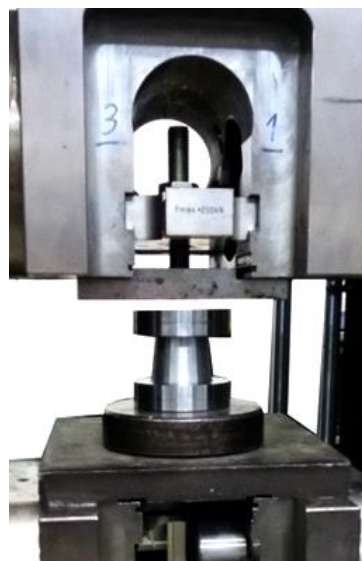
شکل ۳. نحوه قرارگرفتن نمونه‌های مخروطی دوجداره دوسرگیردار در دستگاه یونیورسال
