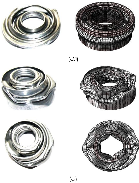
شکل ۸. مقایسه شیوه فروریزش پوسته مخروطی دوجداره تحت شرایط مرزی دوسرگیردار؛ الف) محوری، ب) زاویه‌دار در حالت آزمایشگاهی و شبیه‌سازی
