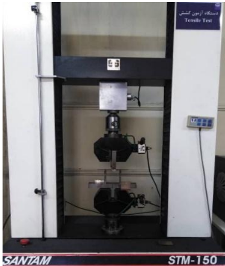
شکل ۱۶. نمای کلی دستگاه آزمون خمش سه نقطه‌ای
