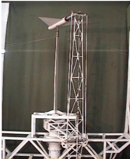
شکل ۷. نصب مدل هواپیمای بال مثلثی روی استند نوسان اجباری
