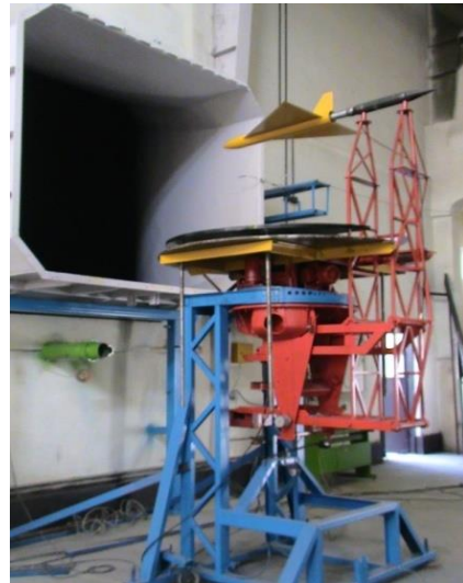
شکل ۶. نصب مدل هواپیمای بال مثلثی روی استند تست استاتیکی
