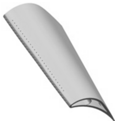
شکل ۱۲. پره سه‌بعدی با سوراخ‌های خنک‌کاری لایه‌ای اضافه شده
