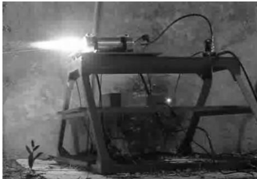
شکل ۷. موتور هیبریدی آزمایشگاهی در حال تست
