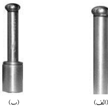
شکل ۹. الف) ابزار فرم‌دهی (ب) ابزار فرم‌دهی با قابلیت چرخش بصورت هرزگرد
