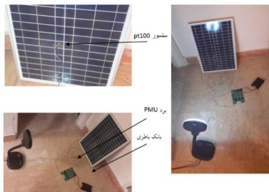
شکل ۲۳. اتصال برد PMU به پنل خورشیدی و بانک باتری
