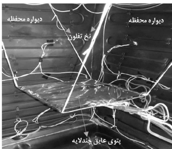
شکل ۹. نحوه قرارگیری مدل عایق چندلایه در محفظه خلا حرارتی
