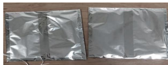
شکل ۷. دو کفه MLI تعبیه شده جهت در برگرفتن صفحات آلومینیومی
