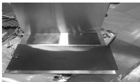
شکل ۵. نحوه قرارگیری گرمکن‌ها در میان صفحات
