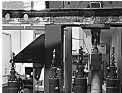
شکل ۳. اسپار نصب‌شده برای اعمال بار به وسیله عملگر خطی
