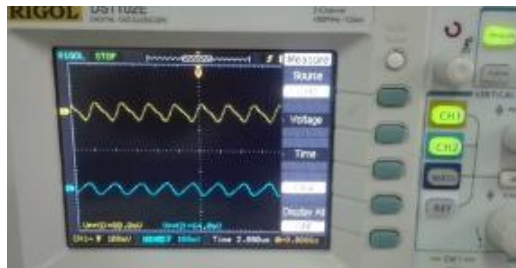
شکل ۱۵. شکل موج‌های ریپل ولتاژ خروجی مبدل‌ها
