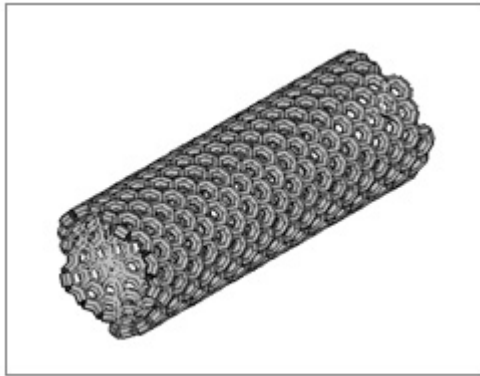
شکل ۷. نمونه‌ای از مدل‌سازی پیوند اتمهای کربن در نانولوله با استفاده از المان‌های تیر در نرم افزار ANSYS
