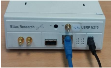
شکل ۵. اتصال کابل اترنت و برق به USRP
