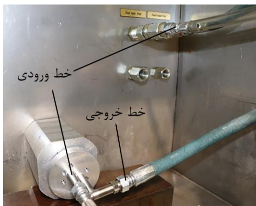
شکل ۵. میز تست راه اندازی پمپ مورد آزمایش
