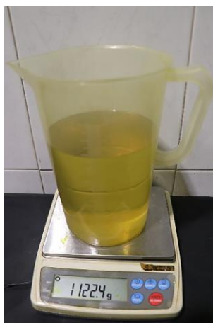
شکل ۱۴. اندازه‌گیری دبی جرمی خروجی پمپ در سرعت ۶۰۰۰ دور بر دقیقه، فشار خروجی ۴۰ پوند بر مجذور اینچ و عدد کاویتاسیون ۰/۰۷
