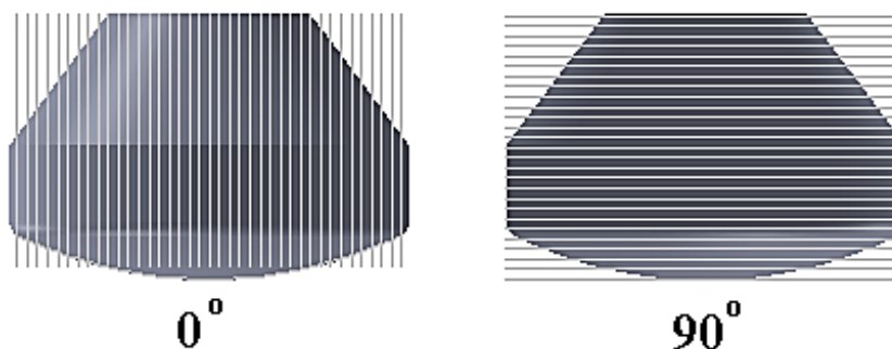
شکل ۴. معرفی جهت‌های لایه‌چینی کامپوزیتی
